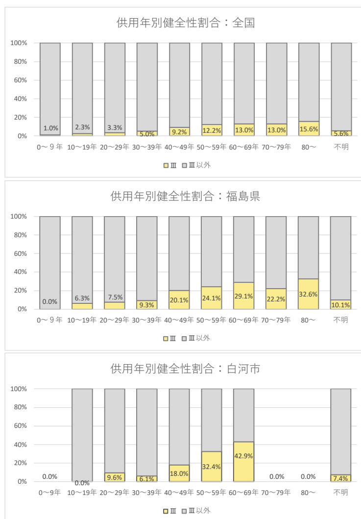
図 2.32 供用年別健全性の割合
