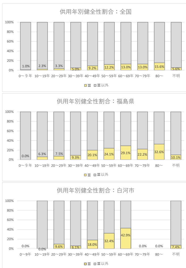
図 2.32 供用年別健全性の割合
